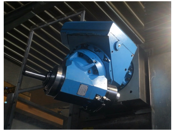
CABEZAL CON DOS EJES GIRATORIOS CNC PERMITE MAQUINADOS EN CUALQUIER POSICIÓN
